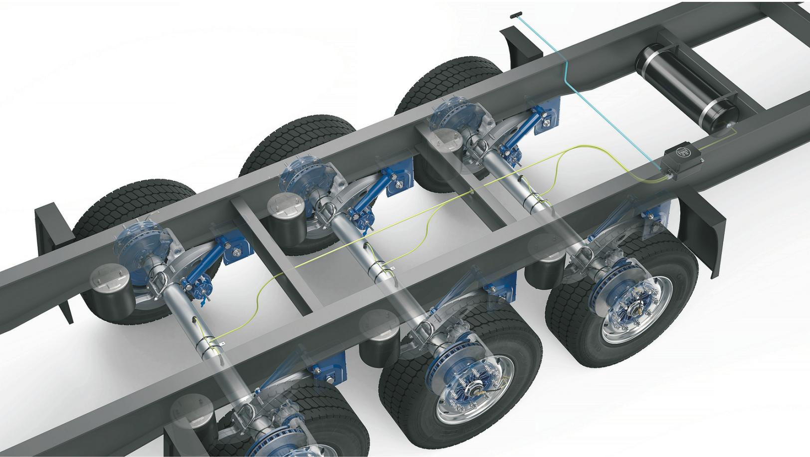
AirSave nutzt die vorhandene Trailer-Pneumatik und sorgt mit einer Verstärkerpumpe vollautomatisch dafür, dass der voreingestellte Reifendruck jederzeit eingehalten wird.
